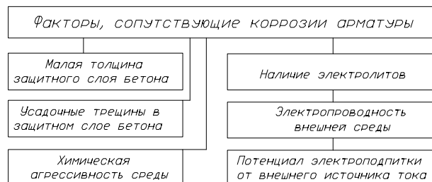
Рис. 1. Классификация факторов, сопутствующих коррозии арматуры
