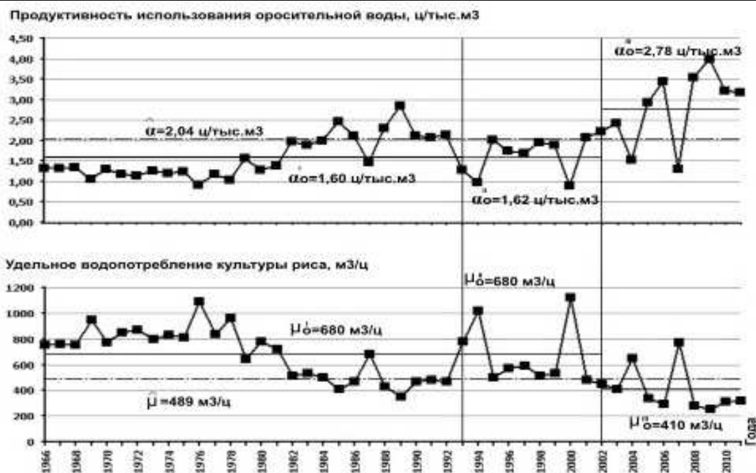
Рис. 2. Динамика изменения удельных показателей эффективности функционирования Придунайских РОС за период 1966-2011гг. (на примере Килийской РОС)
